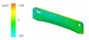
**Alta precisión** después de eliminar los soportes y el arenado, según la medición de un escaneo 3D.
