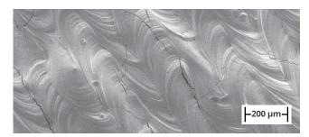
DMP Flex 350 admite material de **tungsteno completamente derretido**. El tungsteno puro fabricado aditivamente no contiene microgrietas y es frágil, lo que limita su uso para componentes cargados de forma mecánica.
