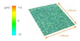
Superficie lisa medida por un microscopio Keyence con una Ra de hasta 5,7  $\mu m.$
