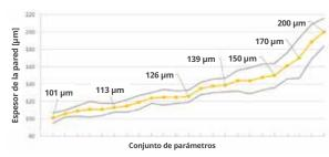
Amplia base de datos de parámetros para un **grosor de pared personalizable** confiable hasta 100 µm.<sup>2</sup>
